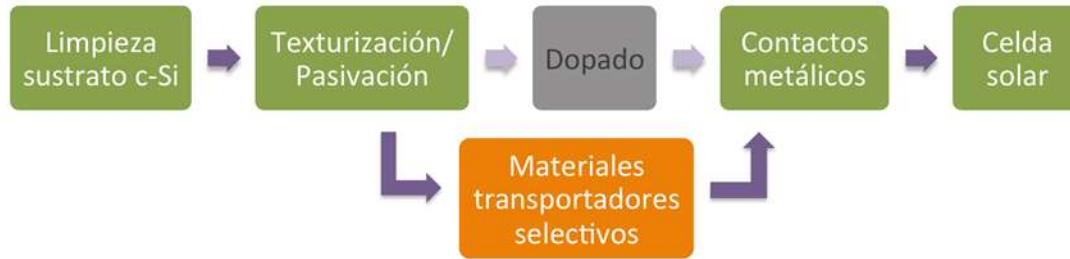
Figura 1. Proceso de fabricación alternativo de una celda solar.
