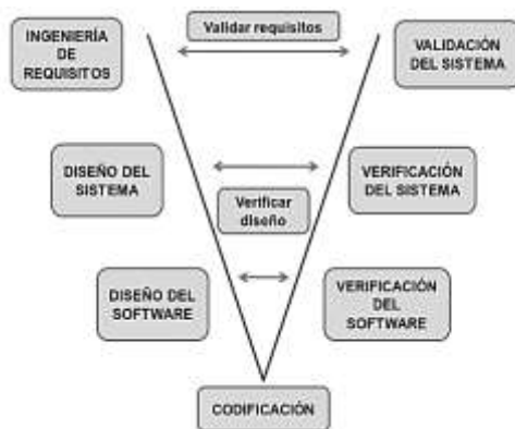
Figura 2. Modelo de ciclo de vida en V, tomado del libro Ingeniería del Software. Un enfoque práctico Roger Presmann.
