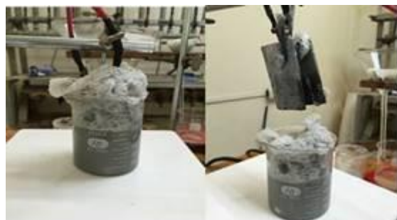
Figura 9. Vista de la segunda prueba, utilizando electrodos de Al.
