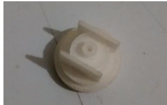
Figura 14. Boquilla impresas con maquina SLS.
