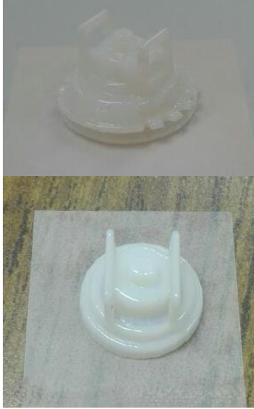
Figura 15. Boquillas impresas con tecnología Polyjet™.
