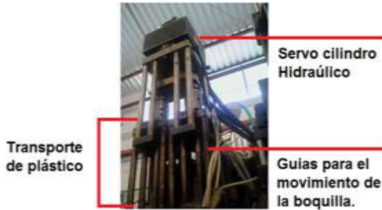
Figura 13. Servo cilindro y los componentes del cabezal.
