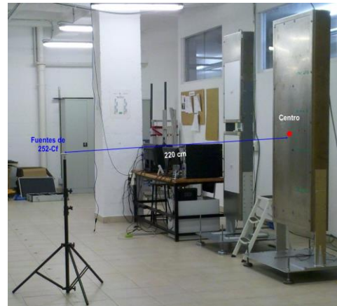
Figura 9. RPM, Monitor de Radiación Tipo Pórtico, Medidas estáticas en el LIN-Caminos UPM.
