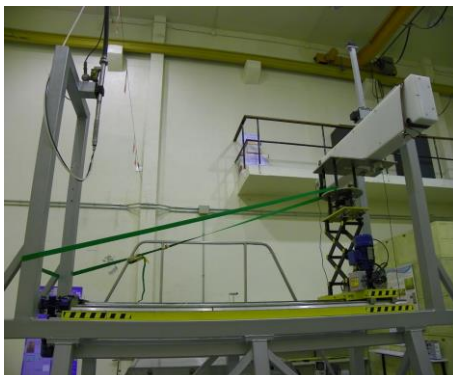
Figura 9. N-48 sobre la bancada del LMN-UPM ante fuentes de neutrones de ^{252}\text{Cf} a 200 cm.
