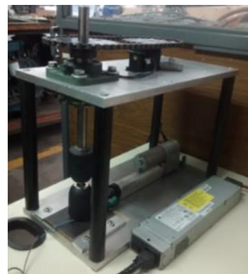
Figura 1. Desarrollo de una máquina de ensayos de fatiga por torsión y por combinación torsión-flexión. (En proceso de patente 2016).
