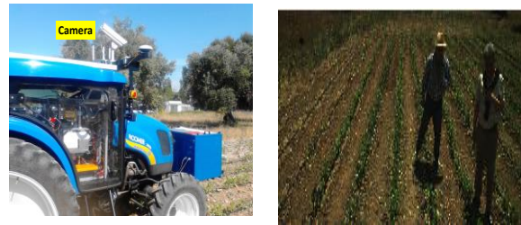
Figura 1. Izda. Tractor equipado con cámaras y sensores, el vehículo es parte de la flota del proyecto RHEA [1]. Dcha. Imagen obtenida con la cámara montada en el tractor.
