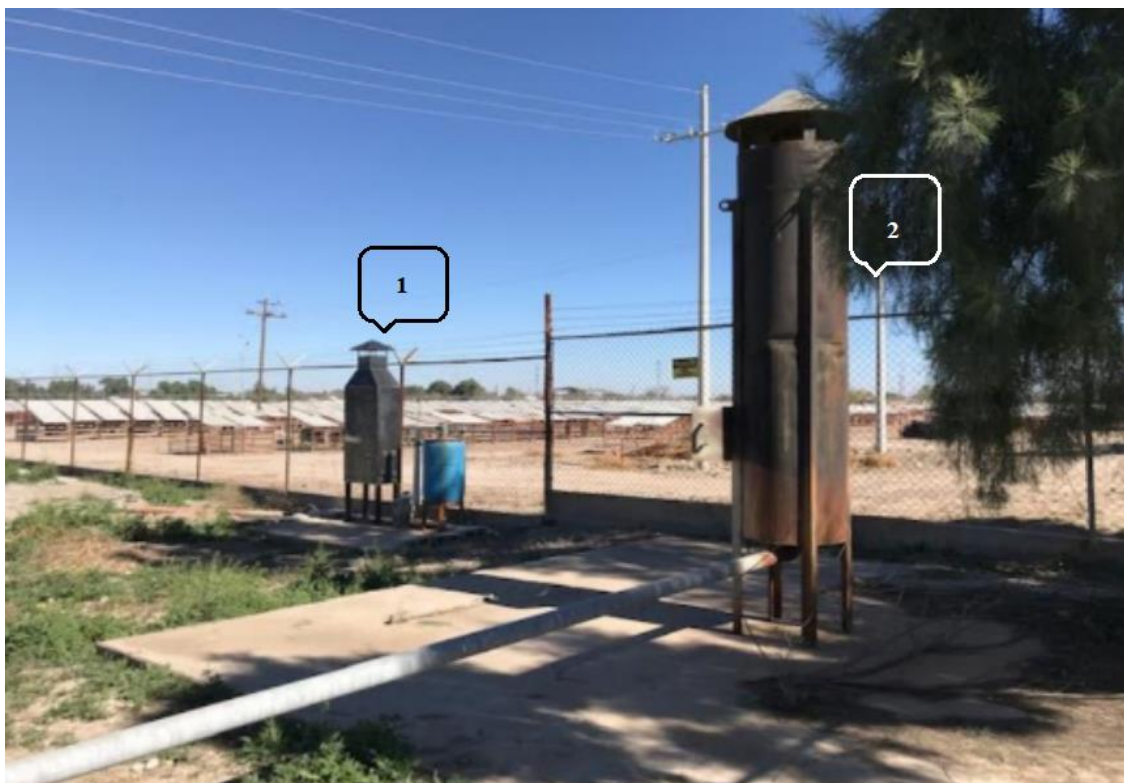
Figura 5. Antorcha en Banco de Ensayo (1) y Antorcha industrial actual (2). Fuente: Elaboración propia.
