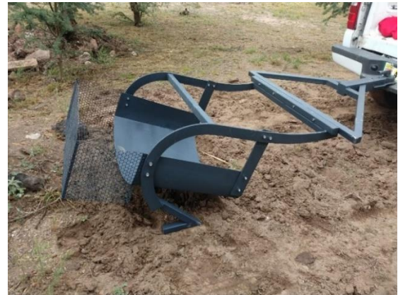
Figura 10. Dispositivo adaptado en un vehículo motorizado para la cosecha de tubérculos. Fuente: Elaboración propia.
