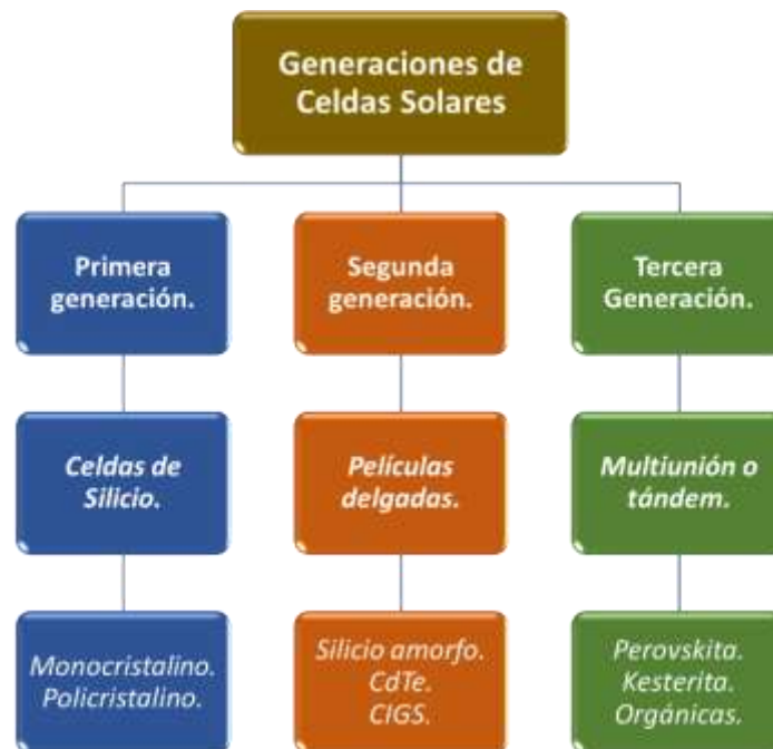
Figura 8. Esquema de la clasificación de celdas solares por generaciones.
