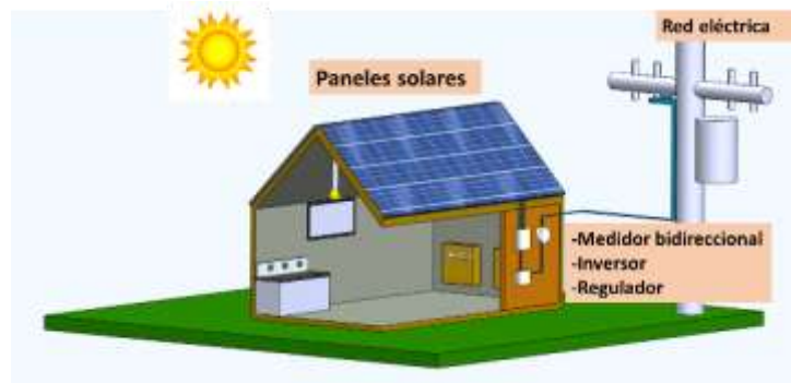
Figura 15. Representación de un sistema fotovoltaico doméstico conectado a la red eléctrica.
