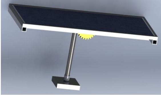
Figura 4. Seguidor solar con incorporación de eje desplazamiento acimutal.
