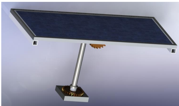
Figura 5. Seguidor solar con incorporación de eje cenit y eje azimutal.
