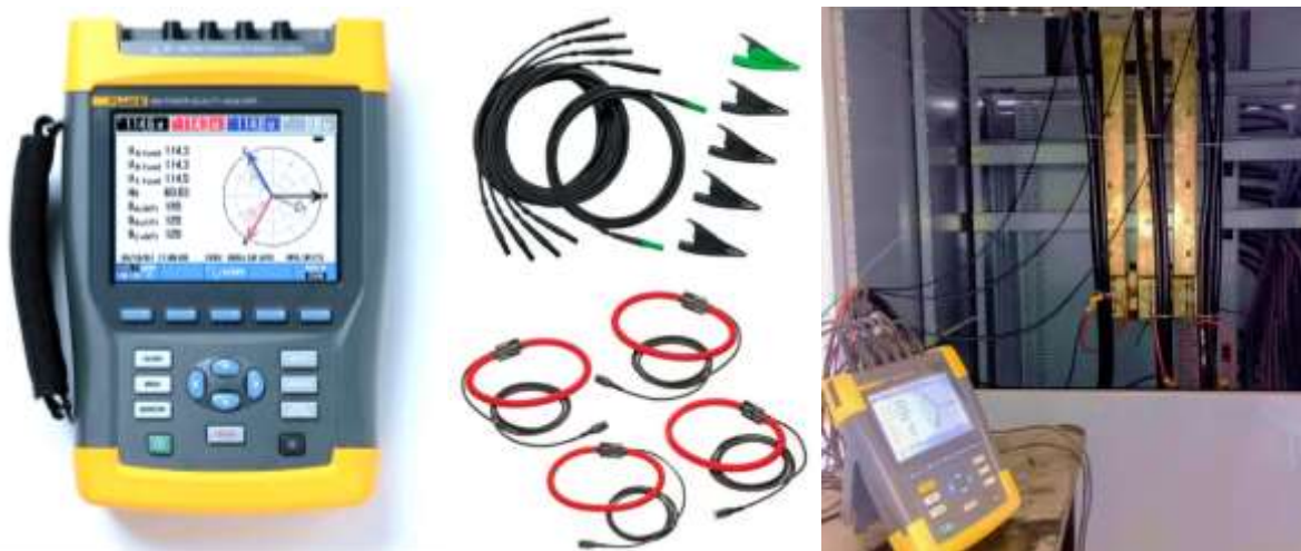
Figura 1. Analizador de calidad de energía Fluke 434-II (izquierda); puntas para medir la tensión eléctrica (centro-arriba); sondas para medir la corriente eléctrica (centro-abajo) [14]. Analizador de calidad de la energía instalado para registrar los parámetros eléctricos (a la derecha).
