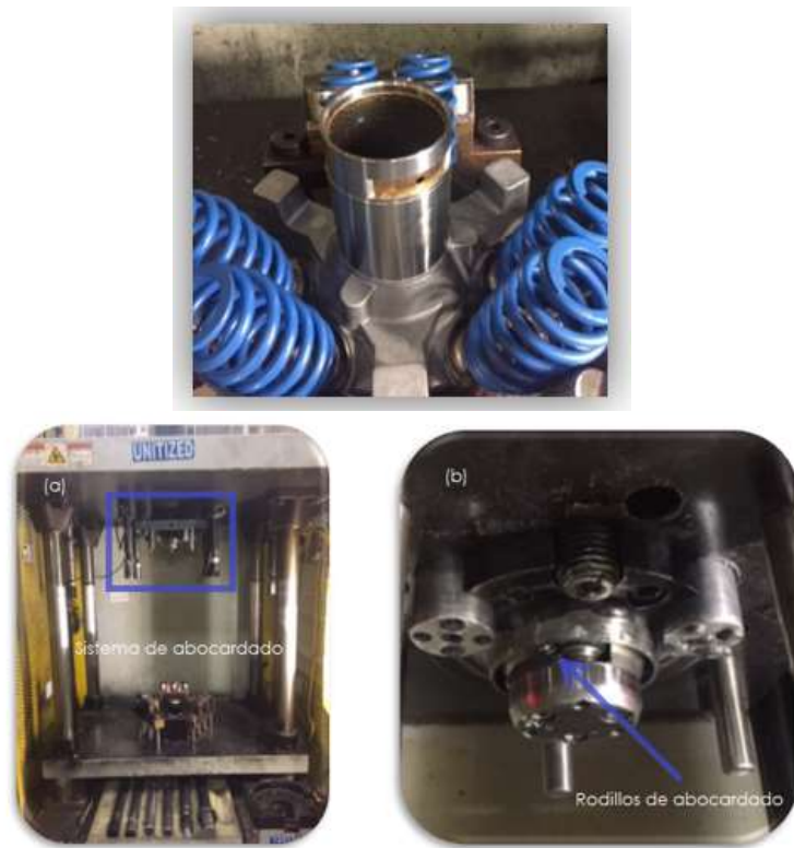
Figura 10. Sistema de abocardado con rodillos deformadores.
