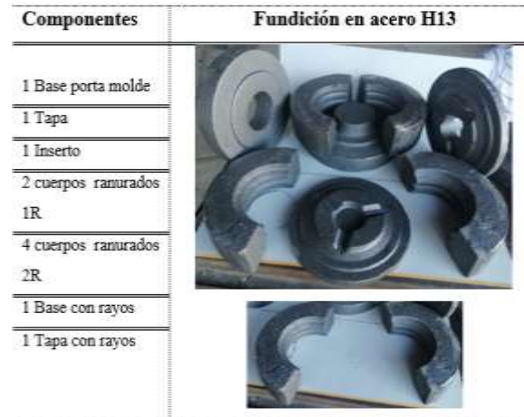
Figura 9. Piezas extraídas de los moldes después de la fundición.
