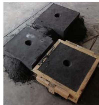
Figura 8. Moldeo de las piezas del molde próximas a fundición.
