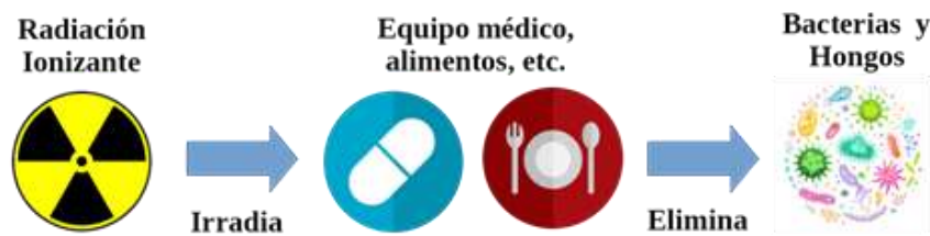
Figura 2. Uso de la radiación ionizante para procesos de esterilización.
