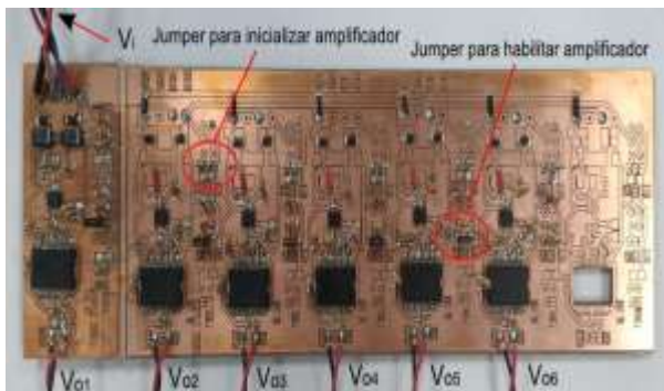
Figura 4. Tarjeta electrónica con seis amplificadores ADA4870 de alta frecuencia.
