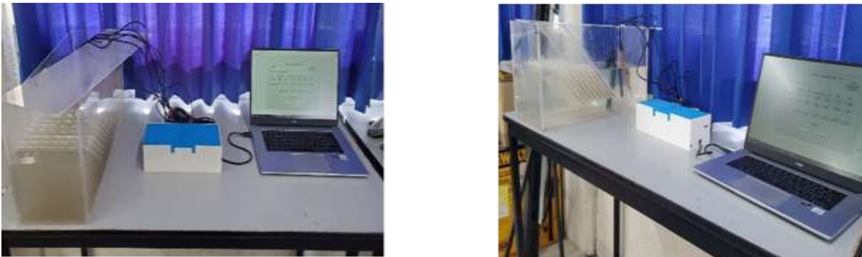
Figura 9. Sedimentador de partículas basado en principio de Boycott.
