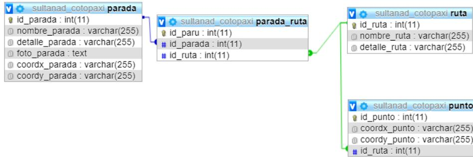
**Figura 11.** Modelo de la base de datos de la aplicación móvil.
